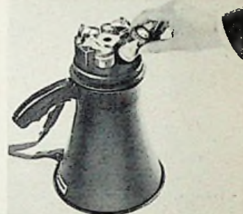
Bild 2. Einsetzen der Trockenbatterien
