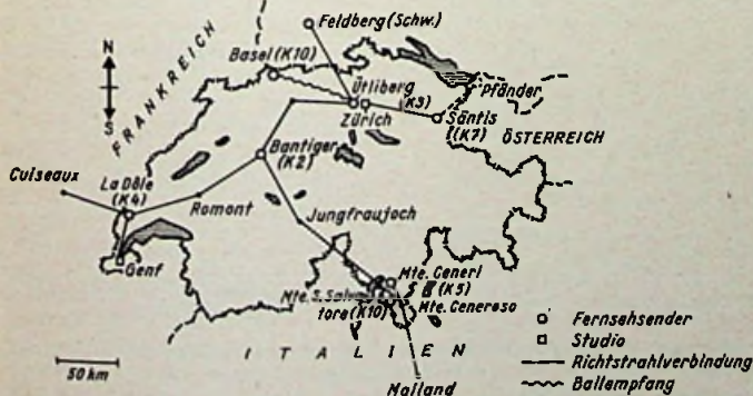
Bild 3. Die Anlage auf dem Säntis schließt die Lücke der wichtigen Ost-West-Verbindung zwischen Österreich (und Osteuropa) und Frankreich via Schweiz. Zugleich bietet die Fernsehanlage auf dem Gipfel dank ihrer nach dem Norden gerichteten Hauptstrahlrichtung weiten Teilen Süddeutschlands die Möglichkeit, das schweizerische Fernsehprogramm zu empfangen. Unsere Karte zeigt die Lage der schweizerischen Fernsehender mit ihren Richtfunkstrecken und den Anschlüssen zum Bundesgebiet, nach Frankreich, Italien und der geplanten Linie nach Österreich (Sender auf dem Pfänder)
