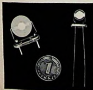
Bild 14. Siemens-Quarz für niedrige Frequenz und höchste Frequenzkonstanz in einem Thermostat mit Kontaktthermometer (aufgeschnitten fotografiert)
